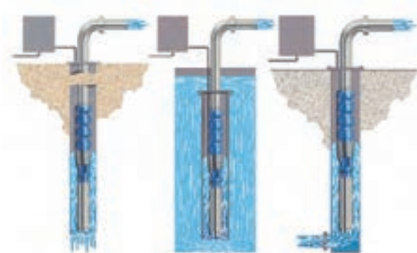
شکل ۵-۵- حالات مختلف نصب پمپ شناور
